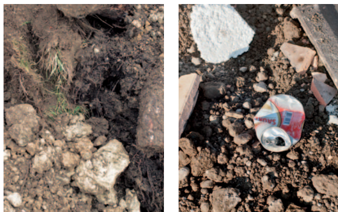
Aushub vermischt mit organischem Material und / oder Bauabfällen
